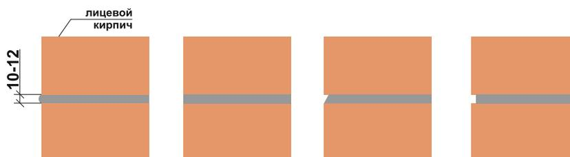
Толщина горизонтальных швов кладки из кирпича должна составлять **10 - 12 мм**, вертикальных швов - **10 мм**.
